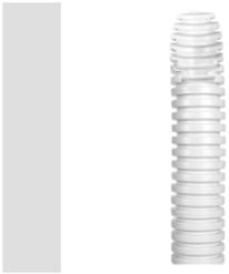
Tubi protettivi pieghevoli leggeri serie FK9 realizzati in PVC con classificazione 22212, disponibili in sei diametri da 16 a 50 mm, nelle versioni con e senza sonda tiracavo, colore grigio RAL 7035. Sono idonei per la creazione di impianti elettrici e/o reti dati e sono consigliati per installazioni sottotraccia in pareti verticali o a soffitto. I tubi FK9 sono conformi allo standard EN 61386-1 e EN 61386-22.
