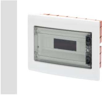
Gamma di centralini da incasso protetto IP40 disponibili nelle taglie da 8 a 72M ed equipaggiati con morsettiere a vite multipolari, 80 A IP20 Disponibili con porta trasparente fumè, particolarmente indicati per i settori terziario ed industriale, e con porta cieca, ideali per dispositivi domotici. Le morsettiere consentono di realizzare un cablaggio semplice ed ordinato riducendo i tempi per la messa in opera del centralino.
