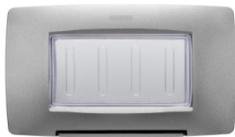
Placche stagne IP55 serie ChoruSmart per fissaggio su scatole incasso tonde/quadrate singole (int. 60mm.) e rettangolari (3 e 4 posti); dotate di supporto e viti lunghe, predisposte per l'installazione di dispositivi serie Chorusmart. Membrana ergonomica, apertura massima del coperchio a 160° agevolata da una comoda impugnatura. Grado IP55 garantito a coperchio chiuso e con montaggio su pareti lisce, impermeabili e senza scanalature.
