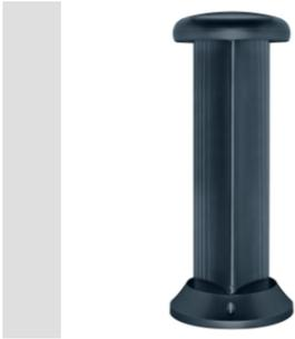
Aparato de iluminación de viales/jardines en extrusión de aluminio, barnizado con polvo poliéster y pasivado trivalente previo. Pantalla plástica. Juntas de silicona anti envejecimiento. Fuente luminosa LED principal alimentada a tensión de red, fuente LED secundaria con lente para efecto spot.
