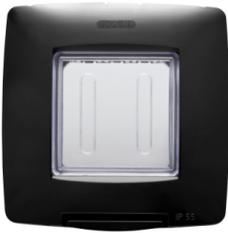
Placas estancas IP55 de la serie ChoruSmart para la fijación en cajas empotradas redondas/cuadradas (int. 60 mm.) y rectangulares (3 y 4 plazas); equipadas con soporte y tornillos largos, diseñadas para la instalación de dispositivos de la serie Chorusmart. Membrana ergonómica, apertura máxima de la tapa a 160° facilitada por una cómoda asa. Grado de protección IP55 garantizado con la tapa cerrada y el montaje en paredes lisas, impermeables y sin ranuras.
