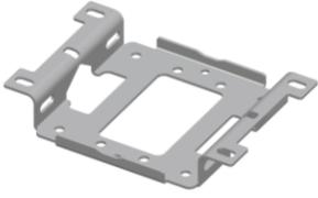
Verzinkte Stahlplatte mit M5 Schrauben. Die Verbindung zweier Platten erlaubt die Montage am Rohrdurchmesser 40 bis 60mm.
