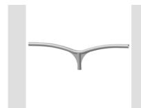
Zweifach-Ausleger aus 3 oder 4 mm dickem, feuerverzinktem und mit Polyesterpulver lackiertem Stahlrohr. Geliefert mit drei M8-Schrauben aus rostfreiem Stahl zur Befestigung an Masten mit 60 mm Durchmesser.
