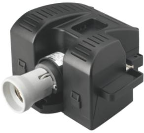
Austauschbare Polyamid Gerätebox für die elektrischen Komponenten, ausgerüstet mit einem Griff für den installationsfreundlichen Wechsel. Zweipoliger Anschlußstecker in Schutzklasse II für max. 2.5 mm<sup>2</sup>. Keramikfassung. Starres Kabel, Durchmesser 1-1.5 mm<sup>2</sup>, doppelt isoliert mit Silikon UG4G4. BiPower Version, Vorschaltgerät mit 2 Leistungsstufen und programmiertem Leistungsumschalter.
