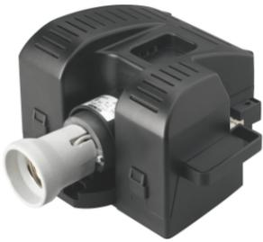
Austauschbare Polyamid Gerätebox für die elektrischen Komponenten, ausgerüstet mit einem Griff für den installationsfreundlichen Wechsel. Zweipoliger Anschlußstecker in Schutzklasse II für max. 2.5 mm<sup>2</sup>. Keramikfassung. Flexibles Kabel, Durchmesser 1-1.5 mm<sup>2</sup>, doppelt isoliert mit Silikon FG4G4. BiPower Version, Vorschaltgerät mit 2 Leistungsstufen und programmiertem Leistungsumschalter.
