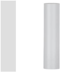
Formteile für starre Rohre mit den Schutzarten IP40 und IP67. Starre schwere Rohre der Baureihe RKB aus PVC, Klassifizierung 4321. Gemäß IEC 61386-1 (CEI 23/80) und IEC 61386-21 (CEI 23/81). Verfügbar in 7 Größen, von 16 bis 63 mm, Länge 3 m. Geeignet für Stark- und Schwachstrom. Installation: Aufputz, abgehängte Decken und Doppelböden.
