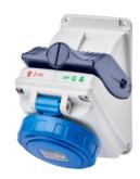
Kompakte Industriesteckdosen gemäß IEC 60309 (EN 60309-1, EN 60309-4), mit einfacher und intuitiver mechanischer Verriegelung in Längsrichtung. Die Verriegelung erlaubt das Stecken oder Ziehen des Steckers nur im ausgeschalteten Zustand und das Schalten nur bei eingestecktem Stecker. Die Baureihe der verriegelbaren Steckdosen ist kombinierbar mit einer Vielzahl an Zubehör für individuelle Aufputz- und Unterputzmontage (auch in rechteckige Dosen mit 3M möglich).
