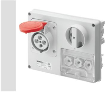
Industriesteckdosen gemäß IEC 309, mit mechanischer Verriegelung und Schutzschalter, erlauben das Stecken oder Ziehen des Steckers nur im ausgeschalteten Zustand und das Schalten nur bei eingestecktem Stecker. Umfangreiche Baureihe mit Drehschaltern, Sicherungssockeln, AUTOMATIKA mit 6kA LS-Schalter C Charakteristik und Versionen mit Sicherheitstrafos. Vielseitig einsetzbar durch Auf- und Unterputzgehäuse, sowie Flansche für die Montage in die Baureihe 68 Q-DIN und 68 Q-MC.
