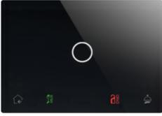
Die Transponder-Kartenleseeinheit ermöglicht die Erkennung von Karten mit RFID-MIFARE® Transpondertechnik (verwenden Sie Karten aus dem Gewiss-Katalog). Die Kartenerkennung wird an die Hotel-Zutrittskontroll- und Verwaltungssoftware GW-HOST gemeldet.
