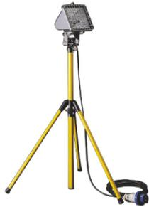
Proiettore polifunzionale in pressofusione di alluminio verniciato a polveri poliestere, per impiego mobile su supporto telescopico regolabile (min. 1m - max. 1,4m). Parabola in alluminio 99.85% brillantato e ossidato anodicamente. Vetro piano temprato 5 mm spessore. Guarnizione silconica anti invecchiamento. Provvisto di gabbia di protezione e di cavo tipo H07RN-F sezione 3x1,5mm<sup>2</sup> di lunghezza 5m e spina IEC 309 16A 2P+T 200-250V IP67 per il collegamento elettrico.
