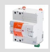
Descrizione Dispositivo di riarmo automatico Sigla ReStart Autotest PRO 2P Tensione nominale AC 230 V Corrente nominale 25 A N. moduli 5 Norma di riferimento EN 50557, EN 61008-1 Frequenza nominale (Hz) 50 Hz Sistema di distribuzione TT - TN-S
