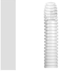
Tubos curvables corrugados ligeros Serie FK9, fabricados en PVC, clasificación 22212, disponibles en seis diámetros, de 16 a 50 mm, con o sin guía tiracables, color gris RAL 7035. Adecuado para sistemas eléctricos y/o de transmisión de datos. Recomendado para instalación oculta en paredes verticales o techos. Los conductos FK9 cumplen con las normas EN 61386-1 y EN 61386-22.
