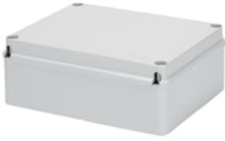
Serie 44 CE: Cajas de derivación de superficie certificadas CSA (conforme a la norma UL 50) y fabricadas en tecnopolímeros de alto rendimiento autoextinguible (GWT 960 ° C). Grado de protección IP56 con paredes lisas, tapa baja y con tornillos (1/4 de vuelta, o en acero inoxidable), adecuado para derivaciones ordinarias, usos especiales y para usos industriales.
