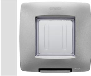
Placas estancas IP55 de la serie ChoruSmart para la fijación en cajas empotradas redondas/cuadradas (int. 60 mm.) y rectangulares (3 y 4 plazas); equipadas con soporte y tornillos largos, diseñadas para la instalación de dispositivos de la serie Chorusmart. Membrana ergonómica, apertura máxima de la tapa a 160° facilitada por una cómoda asa. Grado de protección IP55 garantizado con la tapa cerrada y el montaje en paredes lisas, impermeables y sin ranuras.
