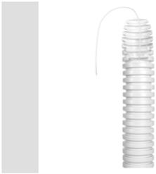
Tubi protettivi pieghevoli leggeri serie FK9 realizzati in PVC con classificazione 22212, disponibili in sei diametri da 16 a 50 mm, nelle versioni con e senza sonda tiracavo, colore grigio RAL 7035. Sono idonei per la creazione di impianti elettrici e/o reti dati e sono consigliati per installazioni sottotraccia in pareti verticali o a soffitto. I tubi FK9 sono conformi allo standard EN 61386-1 e EN 61386-22.
