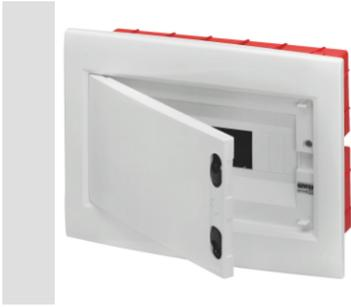
Gamma di centralini da incasso protetto IP40 disponibili nelle taglie da 8 a 72M ed equipaggiati con morsettiere a vite multipolari, 80 A IP20 Disponibili con porta trasparente fumè, particolarmente indicati per i settori terziario ed industriale, e con porta cieca, ideali per dispositivi domotici. Le morsettiere consentono di realizzare un cablaggio semplice ed ordinato riducendo i tempi per la messa in opera del centralino.
