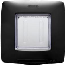
Plaques étanches IP55 gamme ChoruSmart pour boîtes d'encastrement rondes/carrées (entraxe 60mm) et rectangulaires (3 et 4 modules). Plaques étanches équipées de support et de vis longues, pour l'installation des appareils de la gamme Chorusmart. Membrane ergonomique, angle d'ouverture maximum du couvercle 160° facilité par une poignée confortable. Degré IP55 garanti avec couvercle fermé et plaque étanche montée sur parois lisses et étanches, sans rainures.
