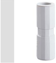
Formteile für starre Rohre mit den Schutzarten IP40 und IP67. Starre schwere Rohre der Baureihe RKB aus PVC, Klassifizierung 4321. Gemäß IEC 61386-1 (CEI 23/80) und IEC 61386-21 (CEI 23/81). Verfügbar in 7 Größen, von 16 bis 63 mm, Länge 3 m. Geeignet für Stark- und Schwachstrom. Installation: Aufputz, abgehängte Decken und Doppelböden.
