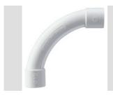
Formteile für starre Rohre mit den Schutzarten IP40 und IP67. Starre schwere Rohre der Baureihe RKB aus PVC, Klassifizierung 4321. Gemäß IEC 61386-1 (CEI 23/80) und IEC 61386-21 (CEI 23/81). Verfügbar in 7 Größen, von 16 bis 63 mm, Länge 3 m. Geeignet für Stark- und Schwachstrom. Installation: Aufputz, abgehängte Decken und Doppelböden.
