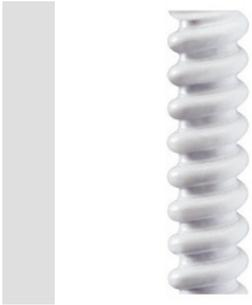
Flexible Rohre DF Diflex aus PVC, Klassifizierung 1311. Gemäß IEC 61386-1 (CEI 23/80) und IEC 61386-23 (CEI 23/83 soweit anwendbar). Die Baureihe besteht aus 4 Größen, von 12 bis 25 mm, in der Farbe Grau. Geeignet für den Schutz von Kabeln und Leitungen in ortsfesten und ortsveränderlichen Installationen. Nicht geeignet für erschwerte Einsatzbedingungen. Installation: Aufputz.
