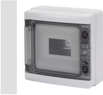
Wassergeschützte Verteiler IP65 von 4 bis 72TE mit transparenter Rauchglastür und mit mehrpoligen Schraub-Klemmleisten, 80 A IP 20. Die technischen Merkmale sind: Front und Gehäuse reversibel, abnehmbare Geräteträger und Abdeckungen mit Ausschnitt, abnehmbare Tür mit 180° Öffnung und Schloss als Zubehör. Die Klemmleisten ermöglichen eine einfache und übersichtliche Verdrahtung und verkürzen die Montagezeit.
