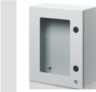
Wassergeschützte Aufputz-Schaltschranke aus Metall. Gemäß IEC 61439-1 (CEI 17/113), IEC 61439-2 (CEI 17/114), IEC 60670-1 (CEI 23/48), IEC 60670-24 (CEI 23/49) und IEC 62208 (CEI 17-87). Erhältlich in 7 Größen, mit transparenten und geschlossenen Türen in der Schutzart IP55. Das Fast&Easy Zubehör aus Metall ermöglicht die Montage von Reiheneinbaugeräten und Leistungsschaltern bis 250A mit einer Zeitersparnis bis 40%. Geeignet für Automation und Verteilung im Innenbereich.
