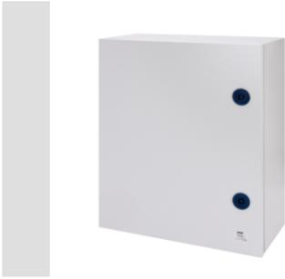
Wassergeschützte Aufputz-Schaltschränke aus Metall. Gemäß IEC 61439-1 (CEI 17/113), IEC 61439-2 (CEI 17/114), IEC 60670-1 (CEI 23/48), IEC 60670-24 (CEI 23/49) und IEC 62208 (CEI 17-87). Erhältlich in 7 Größen, mit transparenten und geschlossenen Türen in der Schutzart IP55. Das Fast&Easy Zubehör aus Metall ermöglicht die Montage von Reiheneinbaugeräten und Leistungsschaltern bis 250A mit einer Zeitersparnis bis 40%. Geeignet für Automation und Verteilung im Innenbereich.
