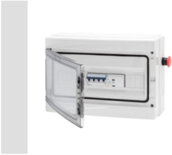
Hauptverteiler für Baustellen vom Typ 68 QP ACS und 68 CDK ACS: Für die Installation direkt nach dem Zähler, für den Schutz der Zuleitung zu den Energieverteilern. Verfügbar in den Bauformen von 17 kW (32A) bis 130kW (250A), alle mit Not-Aus-Taster.
