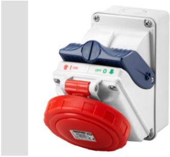
Kompakte Industriesteckdosen gemäß IEC 60309 (EN 60309-1, EN 60309-4), mit einfacher und intuitiver mechanischer Verriegelung in Längsrichtung. Die Verriegelung erlaubt das Stecken oder Ziehen des Steckers nur im ausgeschalteten Zustand und das Schalten nur bei eingestecktem Stecker. Die Baureihe der verriegelbaren Steckdosen ist kombinierbar mit einer Vielzahl an Zubehör für individuelle Aufputz- und Unterputzmontage (auch in rechteckige Dosen mit 3M möglich).
