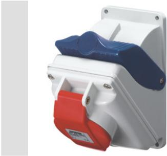
Kompakte Industriesteckdosen gemäß IEC 60309 (EN 60309-1, EN 60309-4), mit einfacher und intuitiver mechanischer Verriegelung in Längsrichtung. Die Verriegelung erlaubt das Stecken oder Ziehen des Steckers nur im ausgeschalteten Zustand und das Schalten nur bei eingestecktem Stecker. Die Baureihe der verriegelbaren Steckdosen ist kombinierbar mit einer Vielzahl an Zubehör für individuelle Aufputz- und Unterputzmontage (auch in rechteckige Dosen mit 3M möglich).
