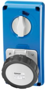
Industriesteckdosen gemäß IEC 309, mit mechanischer Verriegelung und Schutzschalter, erlauben das Stecken oder Ziehen des Steckers nur im ausgeschalteten Zustand und das Schalten nur bei eingestecktem Stecker. Umfangreiche Baureihe mit Drehschaltern, Sicherungssockeln, AUTOMATIKA mit 6kA LS-Schalter C Charakteristik und Versionen mit Sicherheitstrafos. Vielseitig einsetzbar durch Auf- und Unterputzgehäuse, sowie Flansche für die Montage in die Baureihe 68 Q-DIN und 68 Q-MC.
