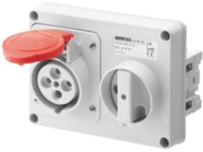
Industriesteckdosen gemäß IEC 309, mit mechanischer Verriegelung und Schutzschalter, erlauben das Stecken oder Ziehen des Steckers nur im ausgeschalteten Zustand und das Schalten nur bei eingestecktem Stecker. Umfangreiche Baureihe mit Drehschaltern, Sicherungssockeln, AUTOMATIKA mit 6kA LS-Schalter C Charakteristik und Versionen mit Sicherheitstrafos. Vielseitig einsetzbar durch Auf- und Unterputzgehäuse, sowie Flansche für die Montage in die Baureihe 68 Q-DIN und 68 Q-MC.
