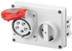
Industriesteckdosen gemäß IEC 309, mit mechanischer Verriegelung und Schutzschalter, erlauben das Stecken oder Ziehen des Steckers nur im ausgeschalteten Zustand und das Schalten nur bei eingestecktem Stecker. Umfangreiche Baureihe mit Drehschaltern, Sicherungssockeln, AUTOMATIKA mit 6kA LS-Schalter C Charakteristik und Versionen mit Sicherheitstrafos. Vielseitig einsetzbar durch Auf- und Unterputzgehäuse, sowie Flansche für die Montage in die Baureihe 68 Q-DIN und 68 Q-MC.
