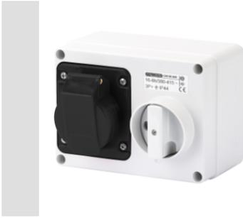
Industriesteckdosen gemäß IEC 309, mit mechanischer Verriegelung und Schutzschalter, erlauben das Stecken oder Ziehen des Steckers nur im ausgeschalteten Zustand und das Schalten nur bei eingestecktem Stecker. Umfangreiche Baureihe mit Drehschaltern, Sicherungssockeln, AUTOMATIKA mit 6kA LS-Schalter C Charakteristik und Versionen mit Sicherheitstrafos. Vielseitig einsetzbar durch Auf- und Unterputzgehäuse, sowie Flansche für die Montage in die Baureihe 68 Q-DIN und 68 Q-MC.
