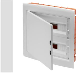
Die geschützten Unterputzverteiler IP40 sind von 2 bis 72TE erhältlich, und sind mit mehrpoligen Schraub-Klemmleisten, 80 A IP 20, ausgestattet. Die geschützten Unterputzverteiler erhältlich mit transparenter Rauchglastür (besonders geeignet für Zweckbau und Industrie) oder mit geschlossener Tür (ideal für den Wohnungsbau); Die Klemmleisten ermöglichen eine einfache und übersichtliche Verdrahtung und verkürzen die Montagezeit.
