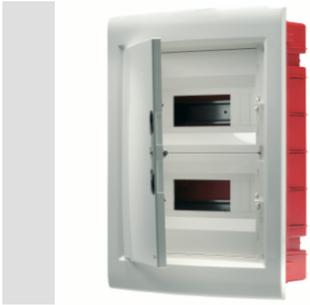
Die geschützten Unterputzverteiler IP40 sind von 2 bis 72TE erhältlich, mit transparenter Rauchglastür (besonders geeignet für Zweckbau und Industrie) oder mit geschlossener Tür (ideal für den Wohnungsbau). Es können ein- und zweipolige 80 A und 125 A Schraub-Klemmleisten montiert werden; Sie ermöglichen eine einfache und übersichtliche Verdrahtung und verkürzen die Montagezeit.
