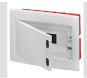
Die geschützten Unterputzverteiler IP40 sind von 2 bis 72TE erhältlich, und sind mit mehrpoligen Schraub-Klemmleisten, 80 A IP 20, ausgestattet. Die geschützten Unterputzverteiler erhältlich mit transparenter Rauchglastür (besonders geeignet für Zweckbau und Industrie) oder mit geschlossener Tür (ideal für den Wohnungsbau); Die Klemmleisten ermöglichen eine einfache und übersichtliche Verdrahtung und verkürzen die Montagezeit.
