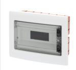
Die geschützten Unterputzverteiler IP40 sind von 2 bis 72TE erhältlich, mit transparenter Rauchglastür (besonders geeignet für Zweckbau und Industrie) oder mit geschlossener Tür (ideal für den Wohnungsbau). Es können ein- und zweipolige 80 A und 125 A Schraub-Klemmleisten montiert werden; Sie ermöglichen eine einfache und übersichtliche Verdrahtung und verkürzen die Montagezeit.
