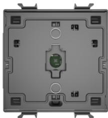
Interrupteur unidirectionnel axial encastrable module. Un bouton poussoir axial sur la face avant pour la commutation d'une charge ON/OFF (fonction bistable/momentanée) ou d'une charge ON temporisée via un contact de sortie avec potentiel. Le dispositif doit être complété avec la clé des boutons avant disponible. Le dispositif a N.3 DIP-switches, situé à l'arrière de l'appareil, pour la configuration des fonctionnalités.
