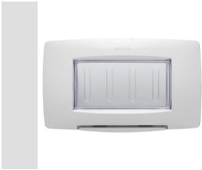
Plaques étanches IP55 gamme ChoruSmart pour boîtes d'encastrement rondes/carrées (entraxe 60mm) et rectangulaires (3 et 4 modules). Plaques étanches équipées de support et de vis longues, pour l'installation des appareils de la gamme Chorusmart. Membrane ergonomique, angle d'ouverture maximum du couvercle 160° facilité par une poignée confortable. Degré IP55 garanti avec couvercle fermé et plaque étanche montée sur parois lisses et étanches, sans rainures.
