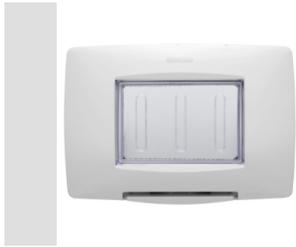
Plaques étanches IP55 gamme ChoruSmart pour boîtes d'encastrement rondes/carrées (entraxe 60mm) et rectangulaires (3 et 4 modules). Plaques étanches équipées de support et de vis longues, pour l'installation des appareils de la gamme Chorusmart. Membrane ergonomique, angle d'ouverture maximum du couvercle 160° facilité par une poignée confortable. Degré IP55 garanti avec couvercle fermé et plaque étanche montée sur parois lisses et étanches, sans rainures.
