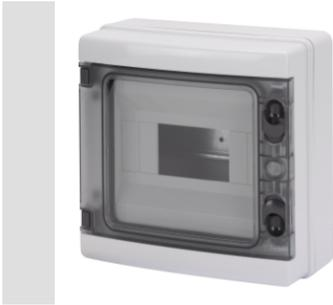
Gamma di centralini stagni IP65 da 8 a 72M, in versione con porta trasparente fumè ed equipaggiati con morsettiere a vite multipolari, 80 A IP20. Accorgimenti tecnici: fondi e frontali reversibili, telai e pannelli finestrati estraibili e portelle con apertura fino a 180° sganciabili ed accessoriabili con serratura di sicurezza. Le morsettiere consentono di realizzare un cablaggio semplice ed ordinato riducendo i tempi per la messa in opera del centralino.
