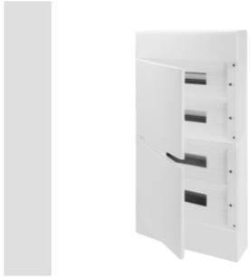
Gamma di centralini da arredo, protetti IP40, disponibili nelle taglie da 8 a 72M. Garantiscono un'elevata integrazione estetica ed sono equipaggiati con morsettiere a vite multipolari, 80 A IP20. Disponibili con porte trasparente fumè o cieche bianche accessoribili con serratura di sicurezza e contraddistinte dal sistema di apertura e chiusura "PUSH". Le morsettiere consentono di realizzare un cablaggio semplice ed ordinato riducendo i tempi per la messa in opera del centralino.
