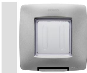
Placche stagne IP55 serie ChoruSmart per fissaggio su scatole incasso tonde/quadrate singole (int. 60mm.) e rettangolari (3 e 4 posti); dotate di supporto e viti lunghe, predisposte per l'installazione di dispositivi serie Chorusmart. Membrana ergonomica, apertura massima del coperchio a 160° agevolata da una comoda impugnatura. Grado IP55 garantito a coperchio chiuso e con montaggio su pareti lisce, impermeabili e senza scanalature.
