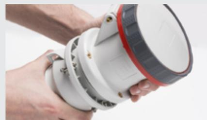
Las versiones 16-32A se distinguen por el cierre patentado SAFE-LOCK ¼ de vuelta de la empuñadura del cuerpo, mientras que las versiones 63-125A presentan un sistema de cierre con tornillos cautivos fijados a insertos de latón fabricados con un reborde de contraste aumentado.
