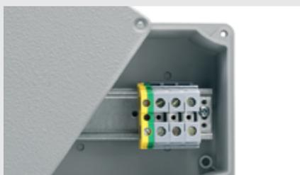
Las cajas con clasificación IP66 pueden utilizarse como cajas de derivación, con opciones para montar placas inferiores o carriles DIN. La tapa está equipada con tornillos de fijación imperdibles de acero inoxidable y la parte inferior contiene un inserto de puesta a tierra.
