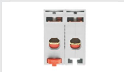
Para garantizar la fijación más segura y la protección frente a posibles contactos con partes bajo tensión, los terminales están equipados con un inserto aislante deslizante de protección. Además, el doble anclaje DIN proporciona una fijación más estable y facilita las operaciones de mantenimiento.
