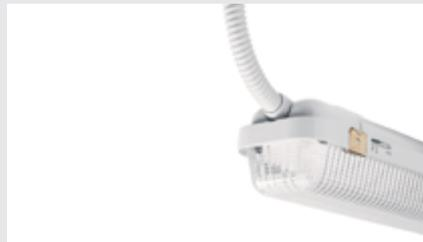
La forma particular de la vaina, que tiene una bobina interior de PVC rígido en espiral y un revestimiento exterior de PVC plastificado, proporciona una gran resistencia al aplastamiento y garantiza la flexibilidad necesaria para cualquier tipo de aplicación y trazado.
