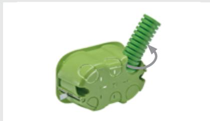
La gama 24 SC Green Wall se ha renovado por completo: la geometría especial de los orificios ciegos permite una cómoda inserción del conducto, que se mantiene firmemente en su sitio. El perfil en "L" permite girar el conducto verticalmente dentro de su accesorio.
