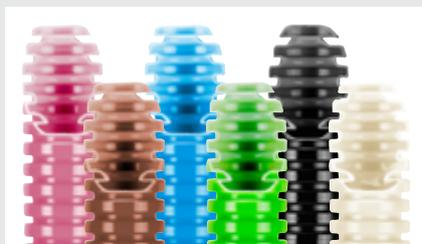
Disponibles en versiones con o sin guía tiracable y en seis colores diferentes para todos los sistemas eléctricos habituales en la construcción. Su perfil anillado le confiere a los tubos una mayor flexibilidad, mayor resistencia a la carga y menor memoria térmica.
