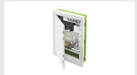
La oferta se completa con los armarios multimedia, que contienen y clasifican los servicios y señales ópticas destinados al apartamento, alojando los componentes pasivos (caja de terminación del apartamento, mezcladores, filtros) y activos (módems, conmutadores, amplificadores de señal) del sistema doméstico.
