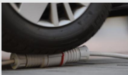
El uso de tecnopolímeros de alto rendimiento y la incorporación de superficies engomadas para proteger las zonas más expuestas a los impactos (en todas las versiones 63-125A) ofrecen una excelente resistencia a los esfuerzos mecánicos (IK09), también a bajas temperaturas (hasta -25 °C).
