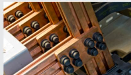
Los orificios pretaladrados, con una separación de 25 mm en las barras planas, permiten una conexión rápida de barras, bandas o cables. Además, las uniones entre barras planas y barras perfiladas pueden realizarse fácilmente mediante juntas especiales.
