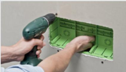
Las lengüetas de fijación de las cajas permiten la fijación en puntales o paneles metálicos de cartón yeso. Las abrazaderas de las cajas de los dispositivos de cableado permiten la instalación en paneles de cartón yeso. Los orificios de fijación permiten el montaje en superficie en caso de renovación.
