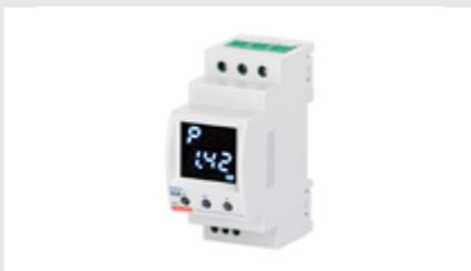
P-COMFORT evita la interrupción de la corriente eléctrica: en caso de sobrecarga, sólo desconecta las cargas no preferentes y las reactiva automáticamente al cabo de un tiempo predefinido, eliminando así cualquier inconveniente debido a un apagón.
