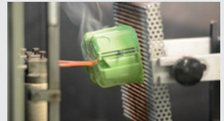
La constante investigación en el campo de los materiales plásticos ha permitido el uso de materiales de alta resistencia mecánica, libres de halógenos y que superan la prueba GWT 850°C Glow Wire Test, de acuerdo con la norma específica del producto y la norma CEI [Comitato Elettrotecnico Italiano] 64/8 del sistema.
