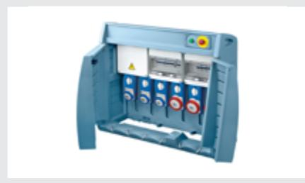
Podemos realizar versiones precableadas, equipadas con tomas con enclavamiento (con o sin base portafusibles) de hasta 63 A o tomas fijas de tipo IEC. También, equipadas con un pulsador de emergencia, puertas cerradas con llave, ganchos para cables SST resistentes a la tracción y asas de transporte situadas en la parte superior del cuadro. Customizadas según las necesidades específicas en cada caso.
