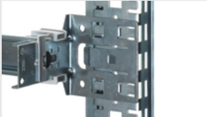
Los soportes de los carriles se han diseñado para un montaje sin tornillos gracias al acoplamiento sobre perfiles funcionales. Además, el innovador soporte permite fijar los carriles a las escuadras y ajustar su profundidad sin necesidad de tornillos ni herramientas.
