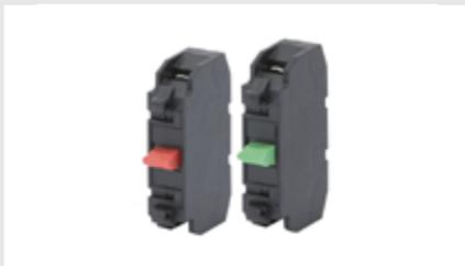
Gracias al práctico mecanismo de acoplamiento por clip de los contactos, los tiempos de montaje de los cuadros se reducen drásticamente. Las versiones de doble contacto aumentan la flexibilidad de instalación y amplían el número máximo de contactos de cada dispositivo.
