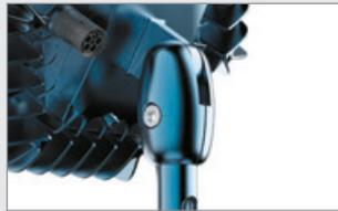
L'articulation et la jonction du cardan au reste du corps de l'appareil permettent d'ajuster aisément la lumière. Cette jonction est assurée par un système de verrouillage robuste à l'aide d'une vis unique et d'un écrou autobloquant carré
